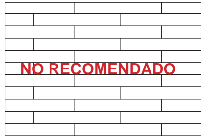
Colocación regular a Media Pieza (no aconsejable)
