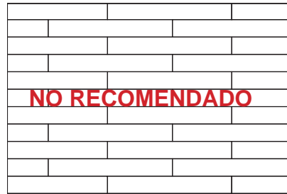
Colocación regular a Media Pieza (no aconsejable)
